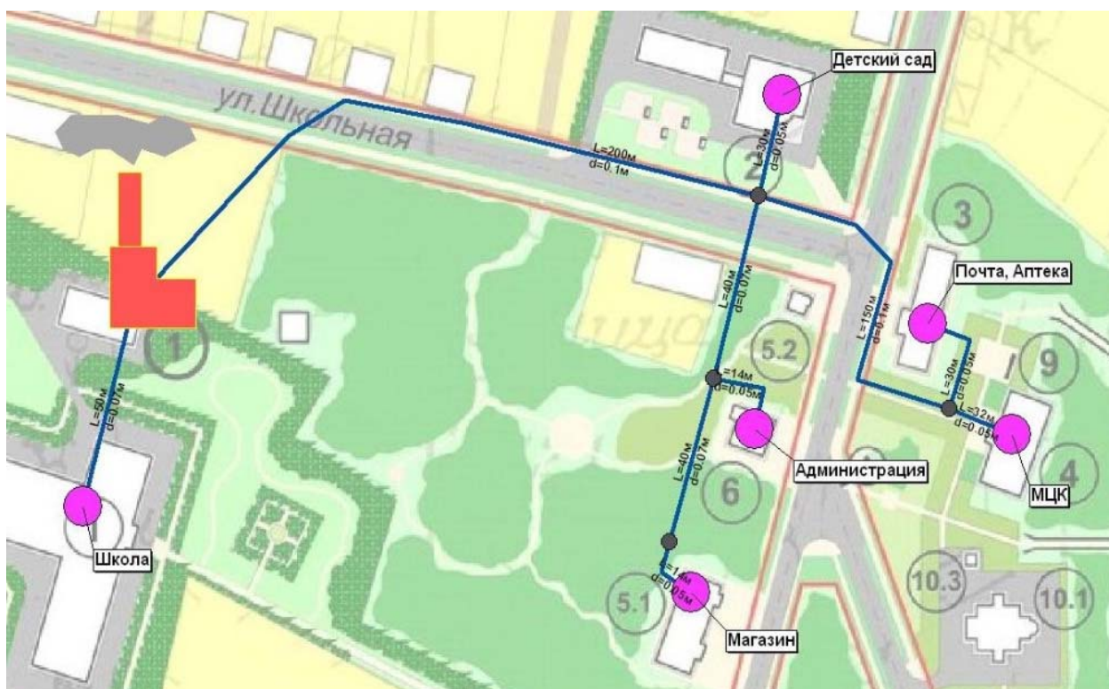
Рисунок2 - Схема централизованного теплоснабжения
